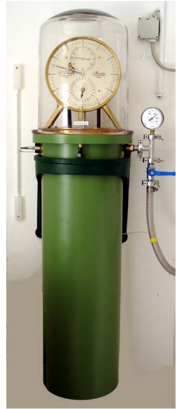
Abb. xxxx: Riefler-Uhr No. 261 Type D von 1909. Kgl. Chronometer Observat. Kiel. Foto: Ihno Fleßner, Rastede
