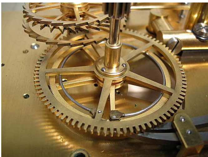
Abb. xxxx – zzzz: Platzhalter Blick in das Werk der Riefler-Uhr No. 227 D-Type von 1909 im Carleton College, Northfield (USA): Fotos: Mark Zach (ebd.)
