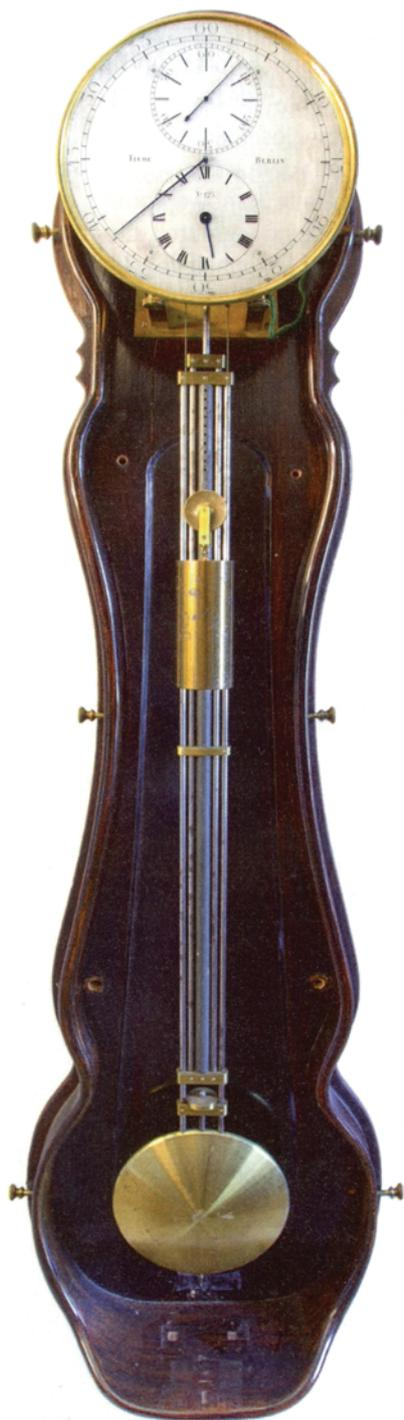
Abb. 3 Die PPU von Tiede Nr.125, ca. 1853/54 in ihrem geöffneten amerikanischen Gehäuse mit Blick auf das für Tiede typische Zink/Stahl Rostkompensationspendel
